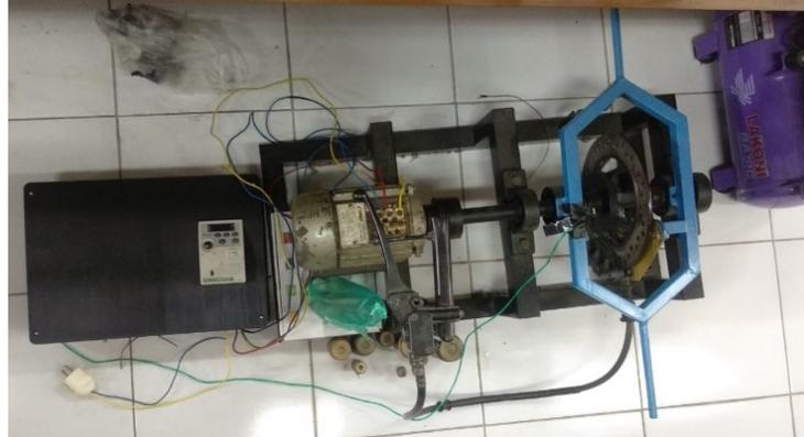
Fig. 3. Prony Brake Testbed
